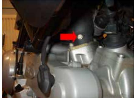
1000 und 1100 Multistrada und 620 Multistrada: Entfernen Sie die Schraube und ersetzen Sie diese mit dem M5 Messinggewinde (Teil 5), drücken Sie dann den Unterdruckfilter auf den Fasszapfen.
