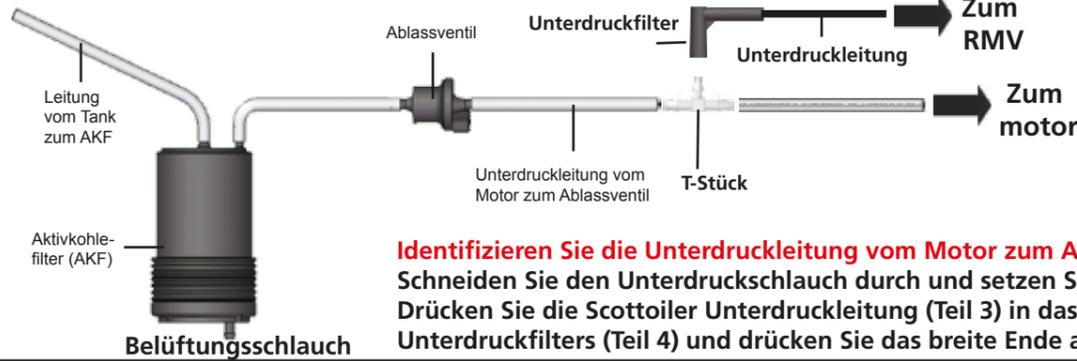
**Hinweis:** Ölen Sie den Unterdruckfilter für einen leichteren Anbau.
