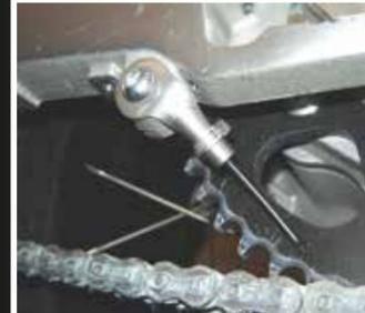
Bringen Sie die kleine Spenderplatte mithilfe der M8 Schraube an der Prismenaufnahme an. Fixieren Sie die Spendereinheit mithilfe der Schlauchschelle. Biegen Sie nun die Spenderplatte vorsichtig, damit die schwarze Düse leicht das Kettenrad berührt, achten Sie dabei darauf, dass der schräge Einschnitt nach außen zeigt.
