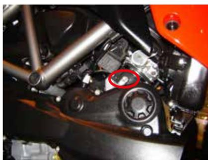
1200 Multistrada bis 2014: Entfernen Sie die Schraube und ersetzen diese mit dem M6 Messinggewinde (Teil 6), drücken Sie dann den Unterdruckfilter auf den Fasszapfen.
