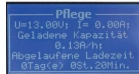
Statusabfrage über die „Mode“-Taste oder Spannungsauswahl-taste. Gerät befindet sich im Pflegemodus (wird zusätzlich über die gelbe LED „Pflege“ angezeigt). Das Display gibt Auskunft über die aktuelle Batteriespannung, aktueller Ladestrom, geladene Kapazität in A/h und die Ladezeit in Tage, Stunden und Minuten.
