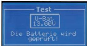
**Test-Modus:** Hat während des Ladens der Ladestrom einen bestimmten Wert unterschritten, wird der Ladevorgang beendet und das Ladegerät schaltet automatisch in den Testmodus.
