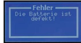
**Hinweis!** Wird der Test nicht bestanden, wird der Akku vom Ladegerät als „defekt“ bewertet, das Gerät schaltet der Ladevorgang ab. Im Display erscheint die Meldung „Die Batterie ist defekt!“.
