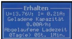
Manuelle Umschaltung im Modus „Erhaltungsladen“ auf die erweiterte Anzeige. Angezeigt werden die Batterieladespannung, der Erhaltladestrom, die Geladene Kapazität (Restkapazität, die erforderlich war, um die Batterie vollzuladen), die Ladezeit, die benötigt wurde.
