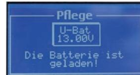
**Pflege-Modus:** Bleibt der Akku dann am Ladegerät angeschlossen, so wird das Gerät folgende Vorgänge zyklisch durchführen: „Erhalten“ und „Pflege“. Diese zwei zusätzlichen Programme sorgen dafür, dass die Batterie nach dem Hauptladevorgang in vollgeladenem und guten Zustand bleibt.
