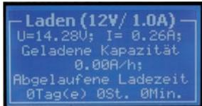
Statusabfrage während des Ladens über die „Mode“-Taste oder Spannungsauswahl-taste. Aktuelle Batterieladespannung, aktueller Ladestrom, geladene Kapazität in A/h und Ladezeit in Tage, Stunden und Minuten.
