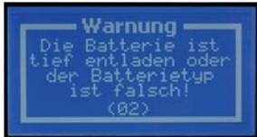
**Hinweis!** Diese Meldung erscheint, wenn die Batterie tiefentladen ist oder es versucht wurde, eine 6V-Batterie mit 12V Ladespannung zu laden. Zahl in Klammern zeigt die noch verbleibende Zeit in Sekunden an um den Ladevorgang wegen der gezeigten Fehlermeldung abzubrechen. Wird der Vorgang nicht abgebrochen, so lädt das Gerät mit der vom Anwender eingestellten Batteriespannung weiter.
