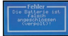
**Hinweis!** Batterie wurde verpolt angeschlossen. Zugleich wird dies durch die rote LED „Verpolt“ angezeigt. Fehlerbeseitigung: Batterieklemmen vertauschen.
