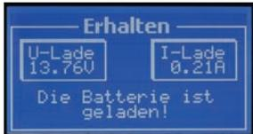
**Erhaltungsladung:** Werden alle Testkriterien erfüllt und der Akku für „Gut“ befunden, schaltet das Ladegerät in den Erhaltungsmodus (Batterie ist voll). Im Display erscheint die Anzeige „Erhalten“ zudem wird die Batterieladespannung und der Erhaltladestrom angezeigt.
