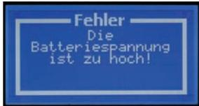
**Hinweis!** Diese Meldung erscheint bei falscher Einstellung der Ladespannung z.B. 6 V. Es wurde aber eine 12 V Batterie zum Laden angeschlossen.
