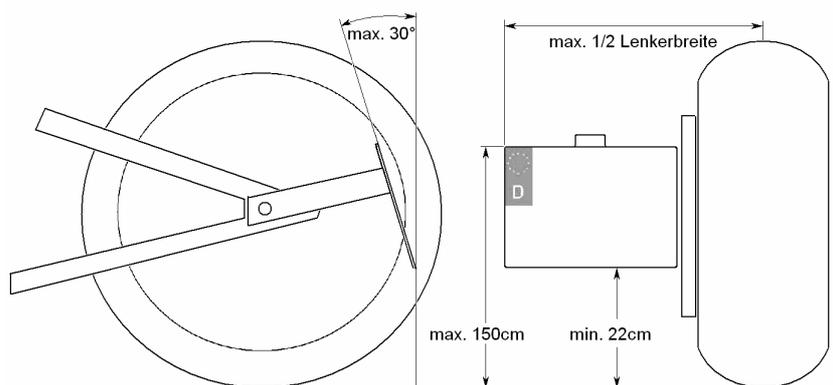
Montieren Sie die Kennzeichenbeleuchtung und schließen Sie diese an das Bordnetz an. Verlegen Sie das Kabel so, dass es nicht in Kontakt mit dem Hinterrad und dem Antriebsriemen kommen kann und befestigen Sie es mit den Kabelbindern!
