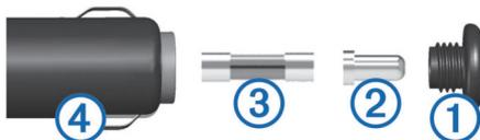
**TIPP:** Verwenden Sie bei Bedarf eine Münze, um das Endstück zu entfernen.
