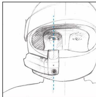
**ASTUCE !** Il y a des charnières dans votre NUVIZ que vous pouvez utiliser pour l'ajuster, ce qui permet des réglages verticaux et horizontaux. Tournez l'affichage pour trouver l'angle de vue optimal. La charnière de NUVIZ permet d'ajuster l'affichage dans 4 directions. Utilisez cela pour bien positionner l'affichage et trouver l'angle de vue optimal pour vous.
