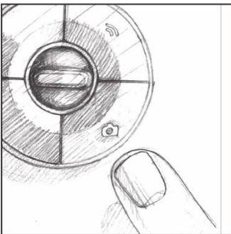
Appuyez sur la bague en plastique autour de l'objectif de l'appareil et tournez l'objectif à la position désirée pour la meilleure vue.
