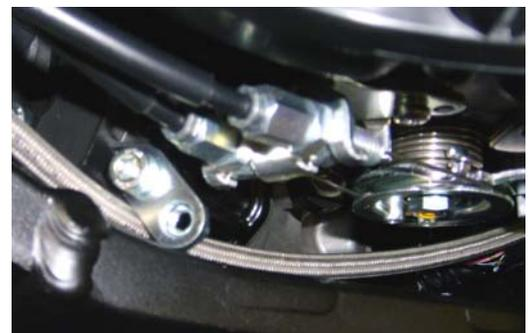
**Câbles électriques (5&6):** Sortir les câbles de leurs guidages d'origines au cadre et les faire passer derrière les tubes de fourche.
