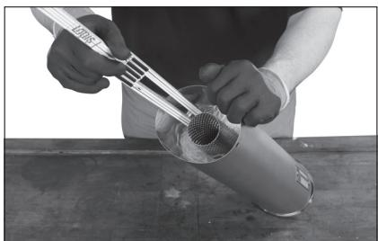
Setzen Sie die Endkappe so auf den Schalldämpfer, dass das Siebrohr korrekt in den Ansatz eintaucht und die Bohrungen für die Nieten wieder fluchten, orientieren Sie sich dabei an der angebrachten Markierung. Richten Sie die Bohrungen genau aufeinander aus, stecken Sie gasdichte Blindnieten mit passendem Durchmesser in die Löcher und ziehen Sie diese mit einer Blindnietzange fest, sodass der Draht der Niete abreißt.
