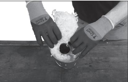
Spingere il nuovo materiale isolante con un utensile idoneo evitando di pressare eccessivamente. In questo modo, inserire l'intero materiale isolante pesato in modo uniforme fino alla parte superiore del silenziatore.
