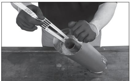
Plaats de eindkap zodanig op de geluiddemper dat de zeefbus correct in het aanzetstuk kan worden geleid en de boorgaten voor de klinknagels weer op één lijn liggen. U kunt zich hiervoor aan de gemaakte markering oriënteren. Breng de boorgaten met elkaar in lijn, steek de gasdichte popnagels met de juiste diameter in de gaten en trek deze met de popnageltang stevig aan, zodat de draad van de nagel niet afscheurt
