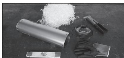
Выберите подходящее, свободное от помех и чистое для работы место. Удобно разложите инструмент и детали для переоборудования, надежно установите мотоцикл на подставку. Обеспечьте возможность демонтажа с глушителя торцевой крышки, например, высверлив для этого крепежные заклепки. Подберите для последующего монтажа подходящие герметичные глухие заклепки и заклепочные клещи из нашей программы принадлежностей.
