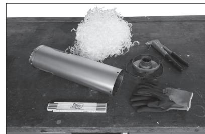
Suchen Sie sich einen geeigneten Platz für ungestörtes, sauberes Arbeiten. Legen Sie sich Ihr Werkzeug und die benötigten Ummauteile zurecht, bauen Sie das Motorrad sicher auf. Stellen Sie sicher, dass sich die Endkappe vom Schalldämpfer demontieren lässt, z.B. indem die Haltenieten weggebohrt werden. Besorgen Sie sich zur späteren Wiedermontage passende gasdichten Blindnieten und eine Blindnietzange.
