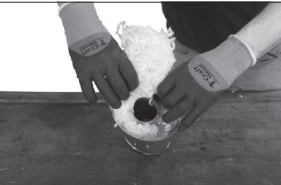
Wsunąć nowy materiał wygładzający za pomocą odpowiedniego narzędzia, bez nadmiernie silnego dociskania. Równomiernie wprowadzić cały odważony materiał aż po górną część tłumika.
