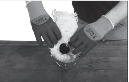
Continúe introduciendo fibra aislante nueva con una herramienta adecuada, sin llegar a comprimirla en exceso. Introduzca de este modo la cantidad fibra aislante pesada anteriormente distribuyéndola de manera uniforme hasta llenar el silenciador.
