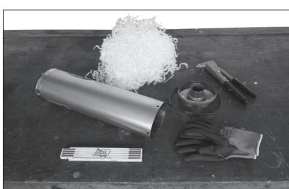
Zoek een geschikte plaats waar u ongestoord en schoon kunt werken. Leg het gereedschap en de vereiste ombouwonderdelen klaar, bok de motor veilig op. Controleer of de eindkap van de geluiddemper kan worden gedemonteerd door bijv. de klinknagels eraf te boren. Koop voor de latere terugplaatsing geschikte gasdichte popnagels en een popnageltang uit ons assortiment.
