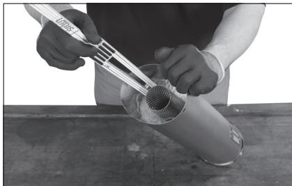
Końcówkę tłumika założyć w taki sposób, aby rura perforowana i otwory na nity ponownie się zbiegły, orientując się według naniesionego oznaczenia. Ustawić otwory dokładnie w jednej linii, wetknąć gazoszczelne nity o właściwej średnicy i osadzić je za pomocą nitownicy do nitów jednostronnie zamkanych, tak aby drut nitów uległ zerwaniu.
