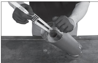
Наденьте на глушитель торцевую крышку таким образом, чтобы перфорированная труба правильно погрузилась в канал и чтобы отверстия под заклепки совпали, ориентируясь при этом на нанесенную ранее метку. Точно совместите отверстия, вставьте в отверстия герметичные глухие заклепки подходящего диаметра и зажмите заклепочными клеммами до обрыва проволоки
