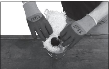
Poussez ensuite le matériau isolant neuf à l'aide d'un outil approprié, sans pour autant le comprimer trop fortement. Remplissez de cette manière le silencieux jusqu'en haut avec la totalité du matériau isolant préalablement pesé en vous assurant qu'il est réparti de manière homogène.
