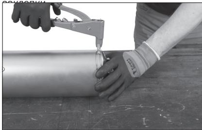
После сборки глушителя герметично смонтируйте его с использованием новой прокладки или уплотнительной пасты на главное выхлопное колено или соединительную трубу выхлопной системы. Прежде чем затянуть все резьбовые соединения для крепления глушителя к мотоциклу, выровняйте его таким образом, чтобы отсутствовали механические напряжения
