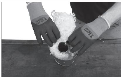
Задвиньте новый шумопоглощающий материал с помощью подходящего инструмента, не утрамбовывая его слишком сильно. Таким образом равномерно разместите весь взвешенный шумопоглощающий материал в глушитель до самого верха.
