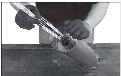
Placez l'embout sur le silencieux de manière à ce que le tube perforé soit correctement inséré dans la base et les alésages pour les rivets soient réalignés. Pour cela, servez-vous des traits préalablement marqués par vos soins. Alignez les alésages l'un sur l'autre avec précision, enfoncez des rivets aveugles étanches aux gaz d'un diamètre approprié dans les trous et serrez-les à l'aide d'une pince à rivets aveugles, de manière à ce que le fil métallique des rivets se sectionne.
