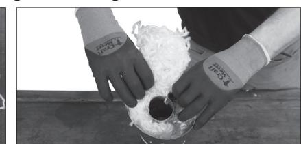
Schuif het nieuwe dempingsmateriaal met een geschikt gereedschap verder door, zonder het te sterk samen te persen. Plaats op deze manier het volledige afgewogen dempingsmateriaal gelijkmatig tot boven in de geluiddemper.
