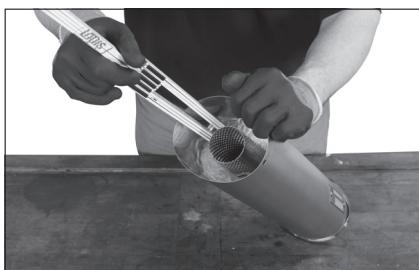
Posizionare la calotta terminale sul silenziatore in modo tale che la canna forata affondi correttamente nell'attacco e i fori per i rivetti siano nuovamente allineati; per fare ciò, orientarsi sull'apposita marcatura. Allineare i fori con precisione, inserire negli appositi fori rivetti ciechi a tenuta di gas con diametro adeguato e serrarli con una rivettatrice fino a spezzare il filo del rivetto.
