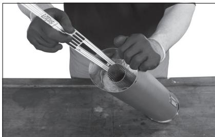
Coloque la tapa en el silenciador guiándose por la marca trazada de tal forma que el tubo perforado se introduzca correctamente en la prolongación y los orificios para los remaches vuelvan a estar alineados. Asegúrese de que los orificios queden perfectamente alineados, introduzca en los orificios remaches ciegos estancos al gas con el diámetro adecuado y apriételos con una remachadora para remaches ciegos hasta romper el alambre del remache.
