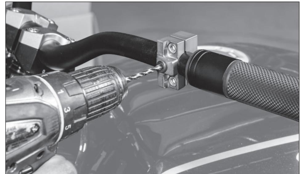
den Lenkerenden hin etwas Spiel haben muss. Die rechte Armatur darf also keinesfalls so positioniert werden, dass die Gasdrehhülse mit Griff gegen das Lenkerende oder die Armatur drückt.
