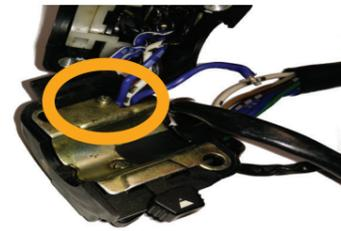
Inserire spugnette più piccole nelle cavità del meccanismo dell'interruttore con delle pinzette.
