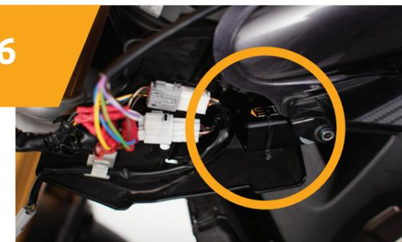
Fissare l'unità STS nella posizione di montaggio. Il logo deve essere rivolto verso l'alto e la freccia nella direzione di guida.
