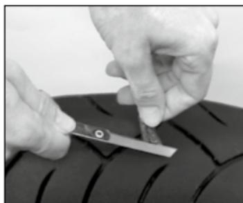
W razie potrzeby pasek uszczelniający można skrócić do około 6 milimetrów (mierzonych od zewnętrznej powierzchni opony).
