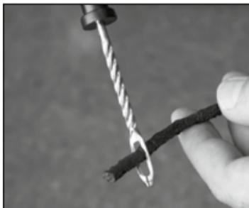
Rimuovere un nastro di tenuta dalla pellicola protettiva, inserirlo nell'occhiello dell'ago dell'utensile di riparazione e applicare l'adesivo speciale.
