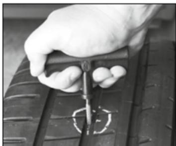
Włożyć narzędzie naprawcze 2 w 1 (1) do otworu w oponie. Oczyścić miejsce uszkodzenia przez wielokrotne wkładanie i wyjmowanie rozwiertaka wzdłuż przebiegu uszkodzenia. Z miejsca przebicia należy usunąć wszelkie zabrudzenia. Uszkodzenie może mieć średnicę maksymalnie 4,5 mm.
