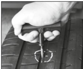
Inserire l'utensile di riparazione 2 in 1 (1) nel foro dello pneumatico. Pulire il punto danneggiato inserendo ed estraendo più volte la lesina nell'area danneggiata interessata. Ogni genere di sporco deve essere rimosso dal punto di perforazione. Il punto danneggiato può avere un diametro massimo di 4,5 mm.
