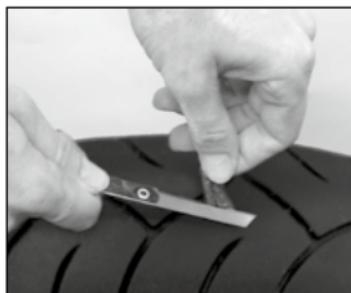
In caso di necessità, il nastro di tenuta può essere accorciato di circa 6 millimetri (calcolati dalla superficie esterna dello pneumatico).
