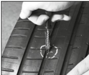
Za pomocą narzędzia naprawczego wsunąć pasek uszczelniający w uszkodzone miejsce, tak aby wystawał na co najmniej 13 milimetrów.
