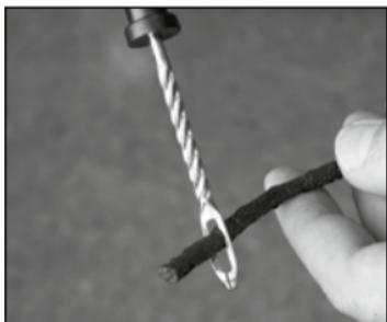
Retire una tira de sellado de la lámina protectora, intodúzcala en el ojo de aguja de la herramienta de reparación y aplique sobre la tira el adhesivo especial.
