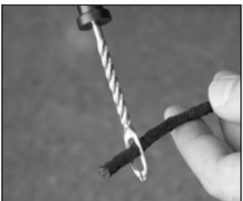
Снимите защитную пленку с ремонтного жгута, проденьте его в ушко ремонтного инструмента и обмажьте его специальным клеем.
