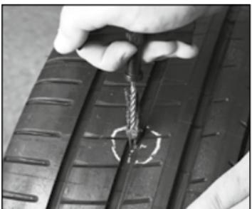
С помощью ремонтного инструмента воткните ремонтный жгут в место прокола так, чтобы он торчал снаружи на минимум 13 мм.
