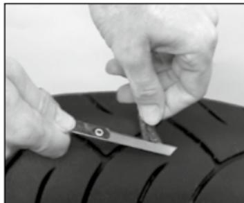
La tira de sellado puede acortarse en caso necesario hasta aproximadamente 6 milímetros (contados a partir de la superficie exterior del neumático).
