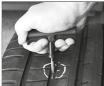
Inserte la herramienta de reparación 2 en 1 (1) en el orificio existente en el neumático. Limpie la zona dañada introduciendo y extrayendo el escariador varias veces a lo largo de la zona dañada. Es necesario eliminar todo rastro de suciedad de la zona perforada. La zona dañada no debe tener un diámetro superior a 4,5 mm.
