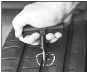
Insérez l'outil de réparation 2 en 1 (1) dans le trou présent dans le pneu. Nettoyez la zone endommagée. Pour cela, introduisez et retirez à plusieurs reprises la râpe dans la zone concernée. Toute saleté doit être intégralement éliminée de la zone percée. Le diamètre de la zone endommagée ne doit pas excéder 4,5 mm.
