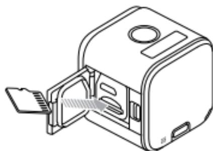
**HINWEIS:** Gehen Sie mit Speicherkarten vorsichtig um. Vermeiden Sie Flüssigkeiten, Staub und Schmutz. Sicherheitshalber sollten Sie die Kamera ausschalten, bevor Sie die Karte einstecken oder herausnehmen. Lesen Sie die Herstellerangaben über den Einsatz in geeigneten Temperaturbereichen.
