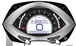
• Auf dem Hauptbildschirm drücken Sie die Taste, um die Funktionskombination, die Sie auf dem Bildschirm anzeigen möchten, auszuwählen. Die alternative Kombination entspricht dem aufgelisteten Kreis: Tageszähler A, Tageszähler B, Gesamt-Motorlaufzeit, Stundenzähler A, B, MAX. Aufzeichnung (Geschwindigkeit / Drehzahl / Temperatur).
