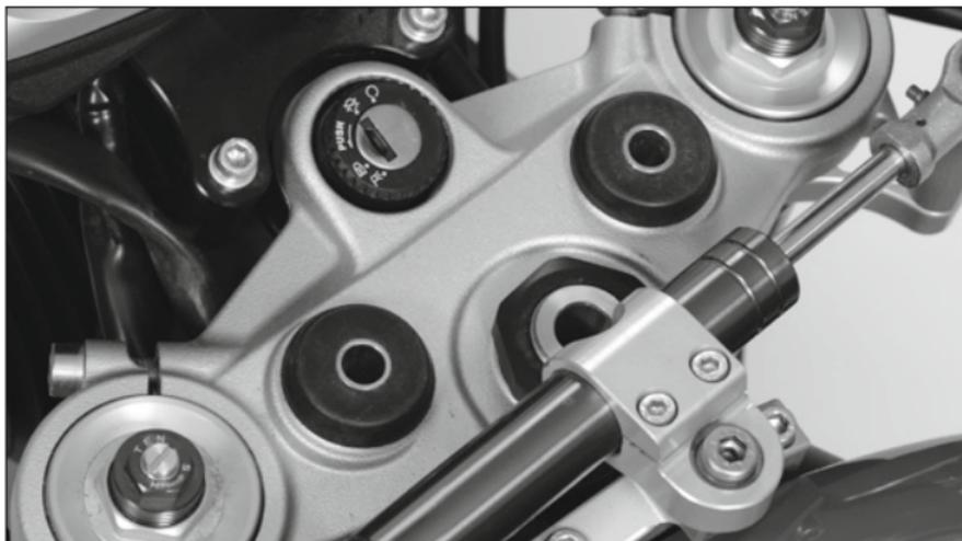
Schraube (9, 10 oder 11) je nach den gegebenen Bedingungen auswählen und mit der Sicherungsscheibe (8) sowie einer Unterlegscheibe (5 oder 7) von unten durch die Gabelbrücke stecken und festhalten. Von oben die zweite größere Unterlegscheibe (5 oder 7) auflegen. Je nach Geschmack bzw. Farbe der Gabelbrücke die schwarze (5) oder die silberne (7) Unterlegscheibe oben verbauen.
