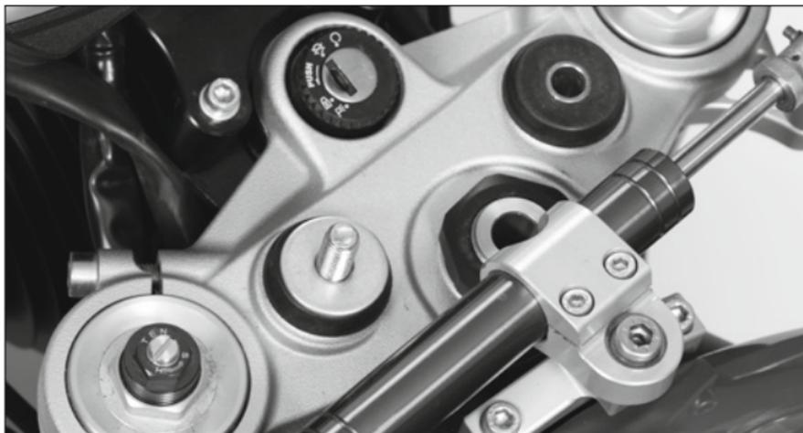
Um den Lenker zu erhöhen, können die gazzini Lenkerklammern bei Bedarf mit den beiliegenden Distanzbuchsen (4) montiert werden. Die Distanzbuchse wird auf der Unterlegscheibe (5 bzw. 7) aufgelegt. Der erhabene Bund zeigt nach oben und taucht in das Unterteil des gazzini Lenkerklammerbocks (3) ein.
