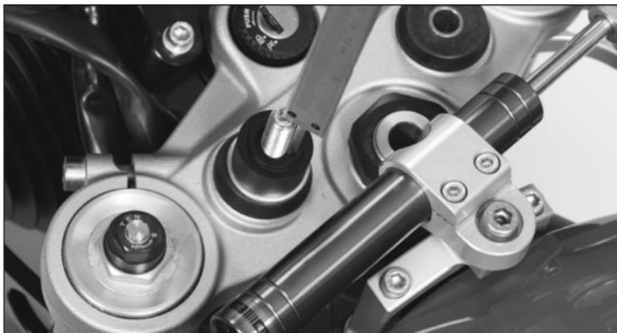
Nun den Gewindeüberstand messen. Dazu die Schraube von unten fest gegen die Gabelbrücke drücken und sicherstellen, dass diese an der Gabelbrücke anliegt. Schraube in dieser Position halten und die Länge des herausstehenden Gewindes messen. Die Länge muss zwischen 10 und 11 mm liegen. Wird dieser Wert nicht erfüllt, ggfs. Schraube tauschen oder einkürzen. Es müssen verzinkte Stahlschrauben M10x1,5 der Güte 8.8 verwendet werden.
