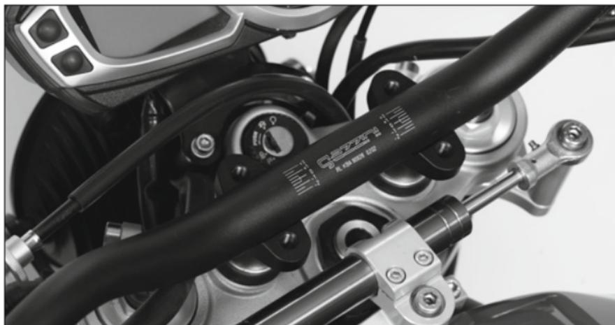
Abschließend werden alle Schraubverbindungen endgültig festgezogen. Für die Lenkerklammern muss ein Drehmomentschlüssel verwendet werden. Die M10 Bolzen der Klemmböcke erhalten ein Anzugsmoment von 35 Nm, die M8 Bolzen der Lenkerklammer 25 Nm.
