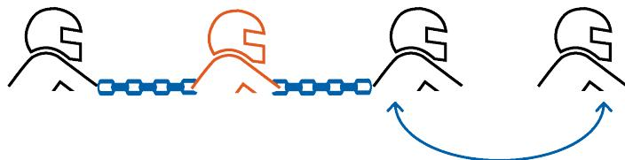
Bluetooth-Intercom-Kopplung muss auf dem anderen Gerät gestartet werden.
