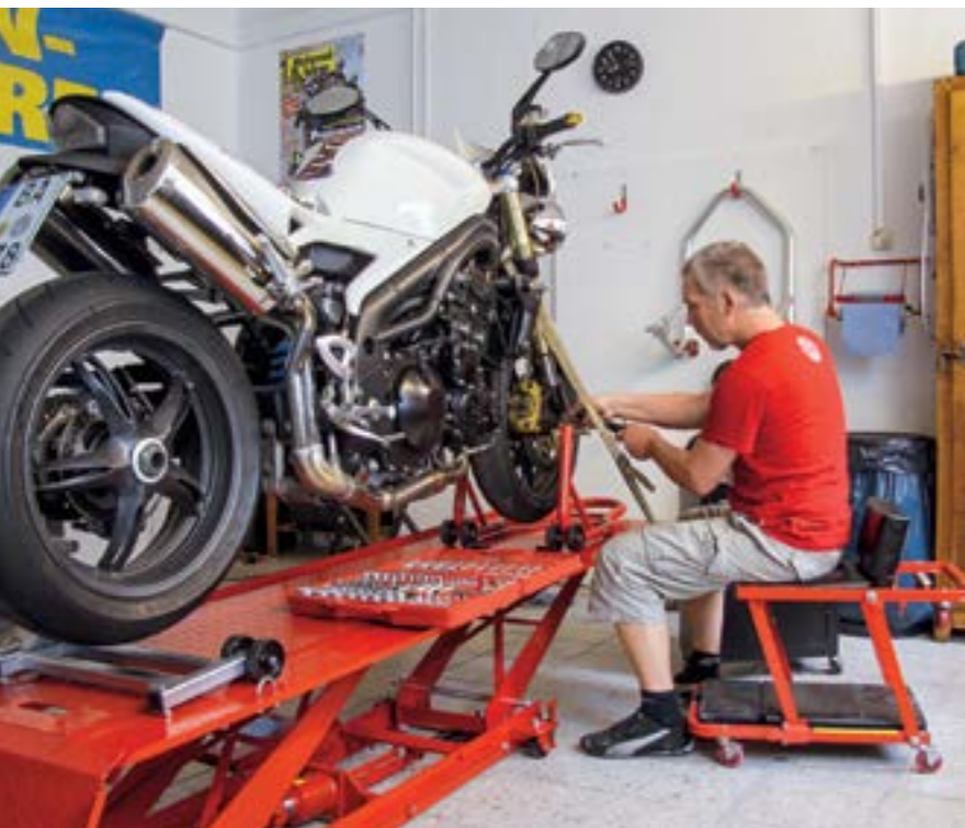
Entspannter Bremsenservice auf halber Hubhöhe. Die Arbeitsfläche bietet Platz für kleine (r. u.) und ausladende Frontheber (r. o.). Spanngurte sind natürlich Pflicht.
