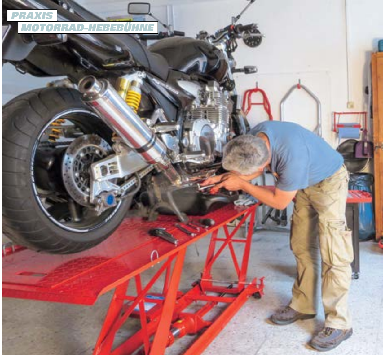
Nie wieder buckeln: Der Ölwechsel am Big Bike XJR1300 gelingt dank stabiler Bühne ohne Verrenkung.
