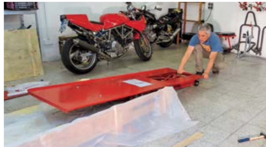
Von der Kiste auf die Piste: Die vormontierte Bühne ist schnell ausgepackt und einsatzbereit. Die Lackierung erfüllt ihren Zweck, mehr nicht. Dafür sind die Stahlteile entgratet (l.). Die Hydraulik mit Sicherheitsventil ist bereits befüllt (Mitte l.).
