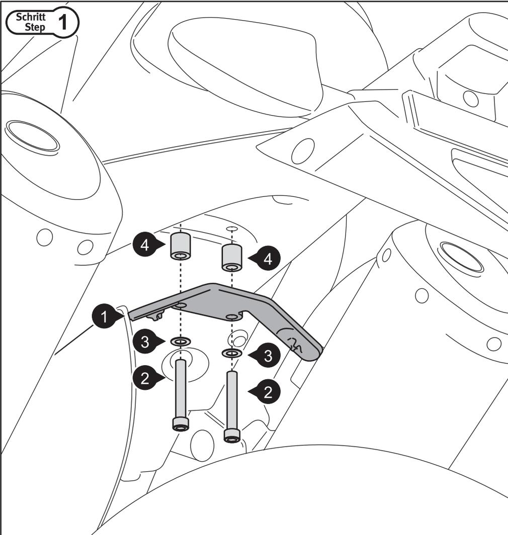
Verschrauben Sie Anbaublech (1) wie gezeigt. Benutzen Sie flüssige Schraubensicherung.
