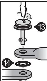
Benutzen Sie einen Schraubendreher, um die Abstandsbügel mit Hilfe der Schnellverschlüsse zu montieren / demontieren. Setzen Sie die Schnellverschlüsse an den mit dem Schnellverschluss-Symbol markierten Verbindungspunkten ein.
