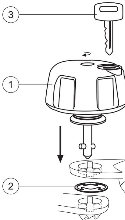
Zur Demontage des QUICK-LOCK-Kofferträgers einfach mit dem Schlüssel das Schloss öffnen und Seitenträger entfernen.
