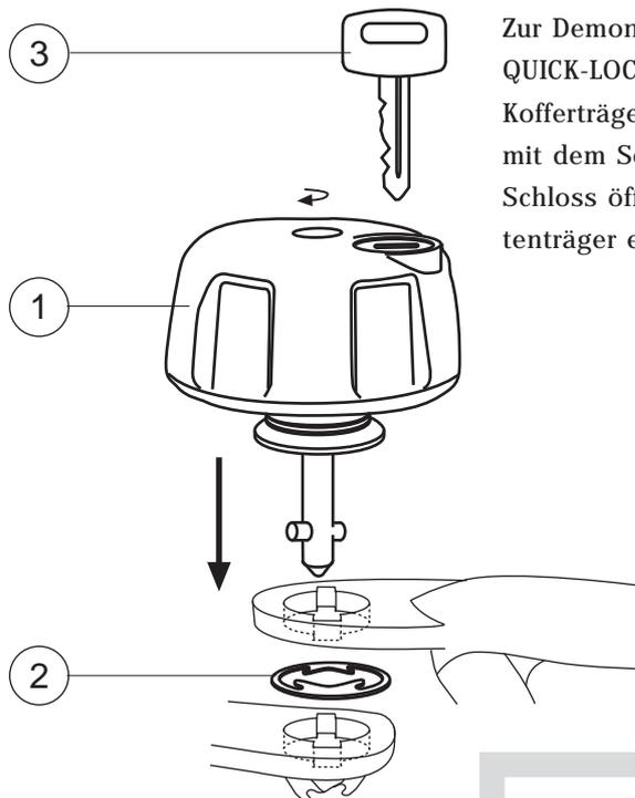
Zur Demontage des QUICK-LOCK-Kofferträgers einfach mit dem Schlüssel das Schloss öffnen und Seitenträger entfernen.
