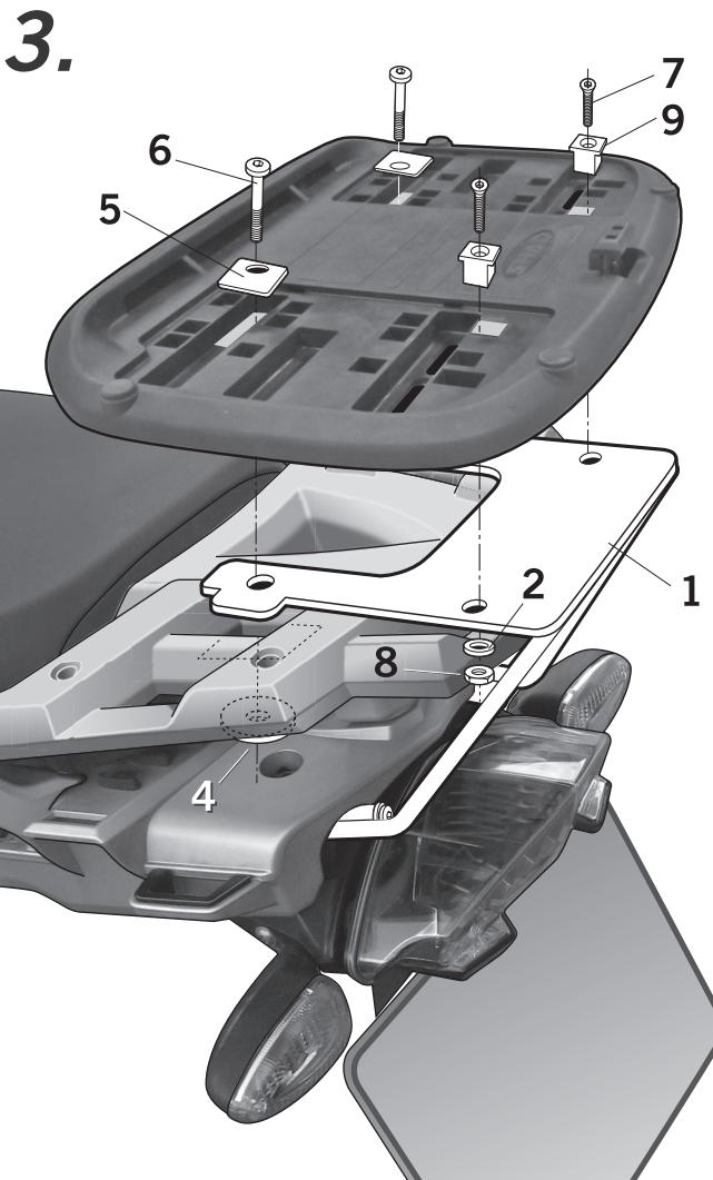
**E** Posicionar la parrilla (D1B48PA) (D1B40PA) no incluida en este KIT. En la zona delantera fijarla al soporte KIT TOP (1) mediante las arandelas especiales (4), las arandelas cuadradas (5) y los tornillos (6) y en zona posterior mediante los tacos rojos (9), los tornillos (7) y las tuercas (8). Por último acabar de montar la parrilla (D1B48PA) (D1B40PA) según sus instrucciones.
