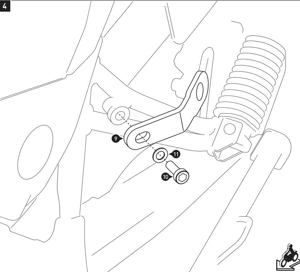
Verschrauben Sie die Befestigungslaschen (9) am Fahrzeug, wie in der Zeichnung gezeigt. Montieren Sie die Befestigungslaschen auf der rechten Fahrzeugseite analog zur linken Fahrzeugseite.
