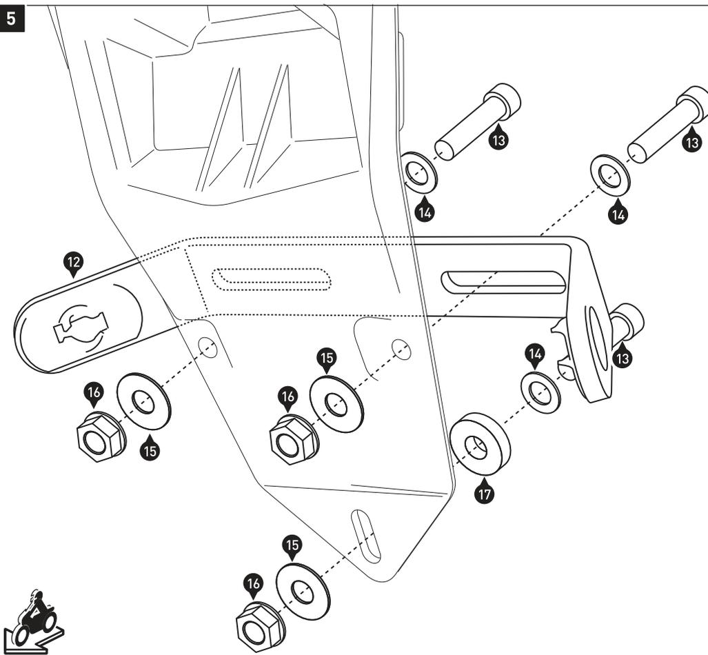
Verschrauben Sie die Querverbinder (12) am Kennzeichenhalter, wie in der Zeichnung gezeigt. Verwenden Sie die Distanzbuchse (17) als Ausgleich unter dem Nummernschild
