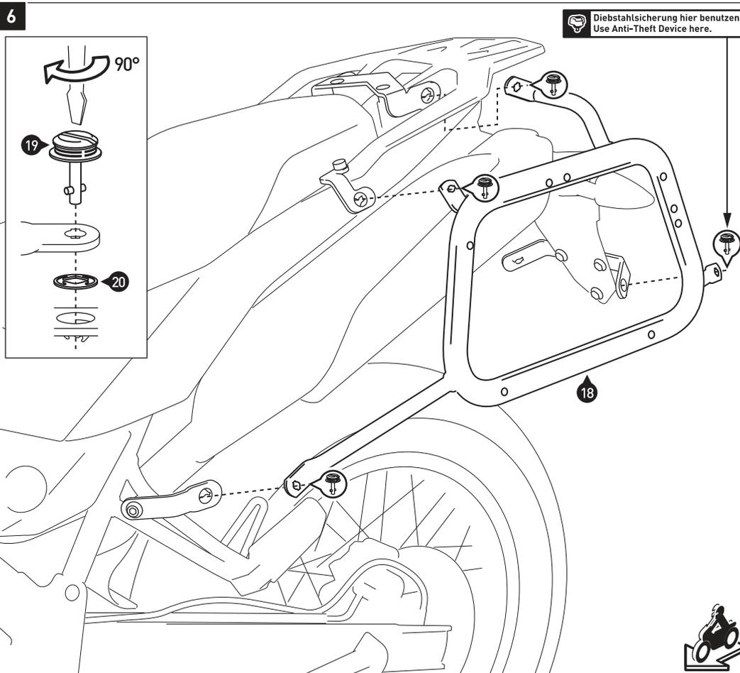
Verbinden Sie die Kofferträger (18) an den Befestigungslaschen und dem Querverbinder mit den Schnellverschlüssen (19). Sichern Sie die Schnellverschlüsse (19) mit den Sicherungsscheiben (20).
