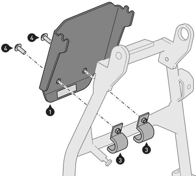
Verschrauben Sie die Motorschutz-Verlängerung (1) mit den Schellen (3) am Hauptständer.
