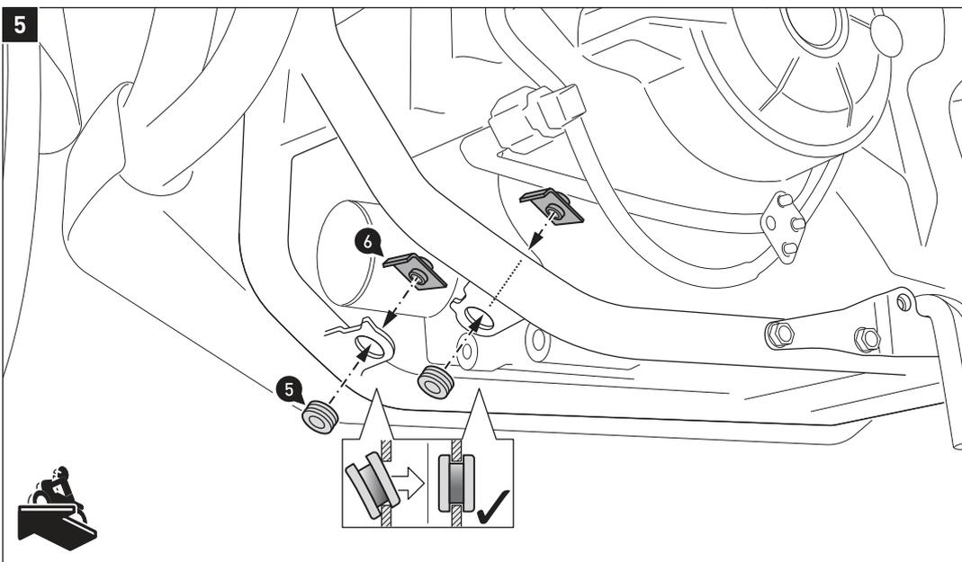
Entfernen Sie die original Gummidämpfer von den vorderen Anbaupunkten.
