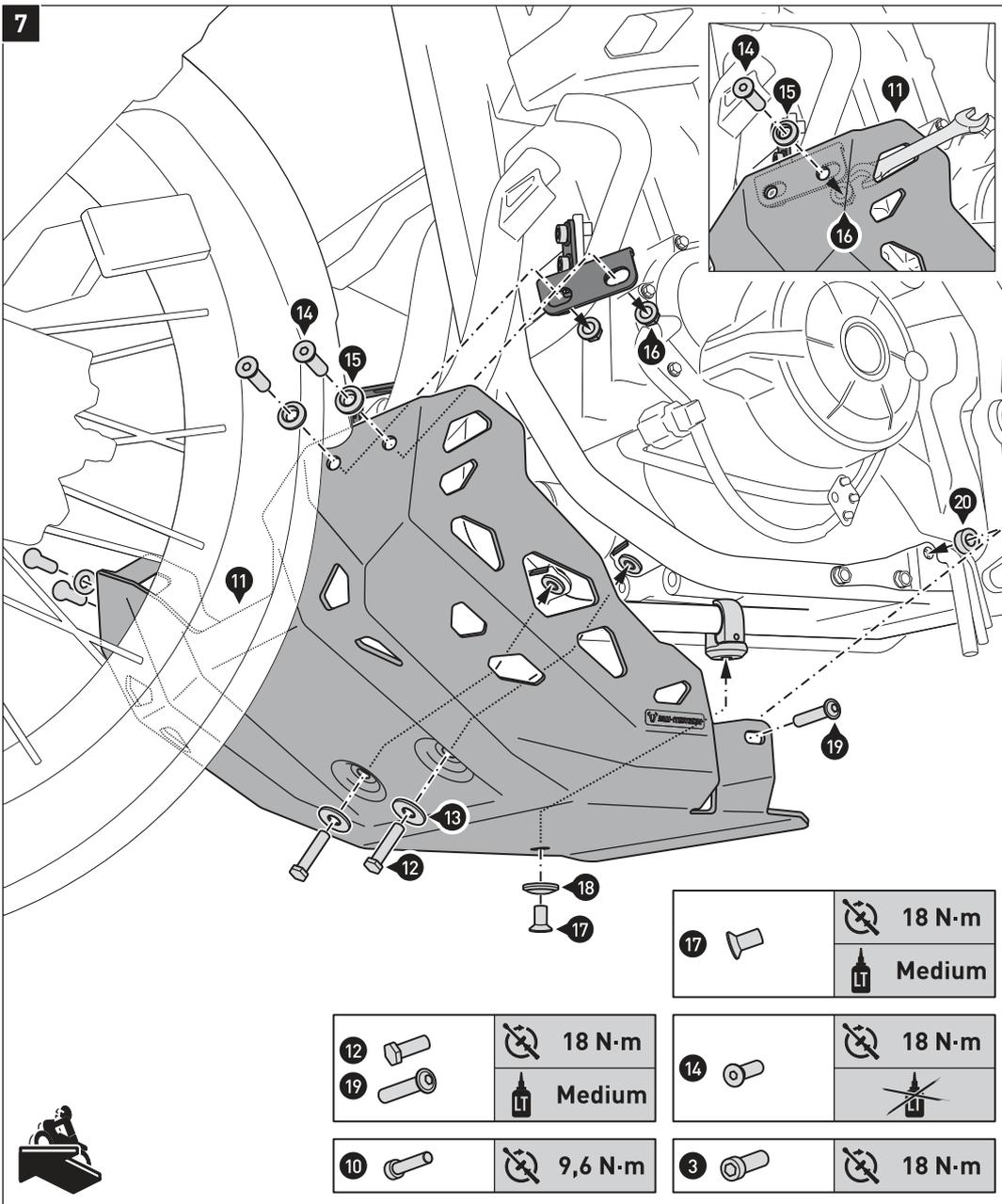
Verschrauben Sie den Motorschutz (11) an den Anbaublechen (1) und (2), und dem Fahrzeugrahmen, wie in der Zeichnung gezeigt.
