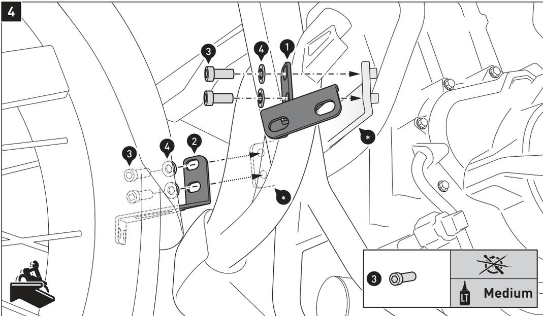
Montieren Sie die Anbaubleche (1) und (2) an den Anbaustreben (\*) des SW-MOTECH Sturzbügels bzw. des Traversen Anbaupaket.
