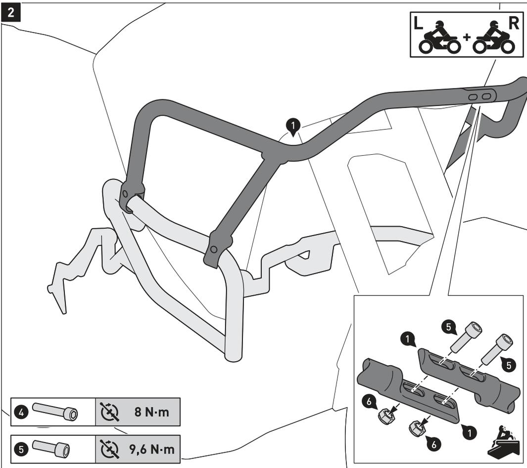
Verschrauben Sie die Sturzbügel (1) an den vorderen Verbindungsstücken miteinander, wie in der Detailzeichnung gezeigt.
