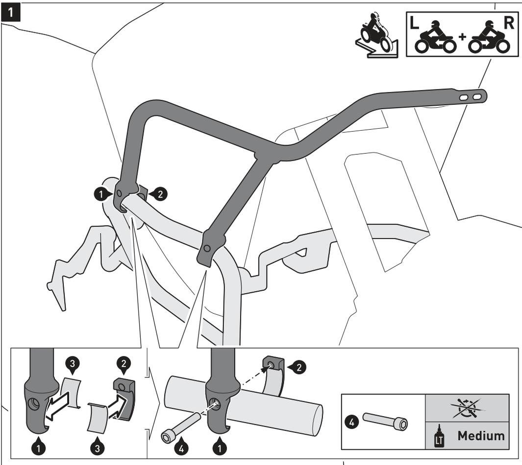
Reinigen Sie die Oberflächen der Schellen der Sturzbügel (1) und der Schellen (2) gründlich von Fett- und Schmutzrückständen.
