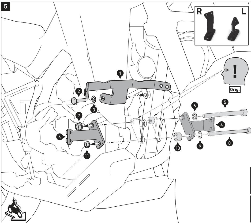
Montieren Sie den Querverbinder (1) und die Anbaustreben (4) am Fahrzeugrahmen, wie in der Zeichnung gezeigt.
