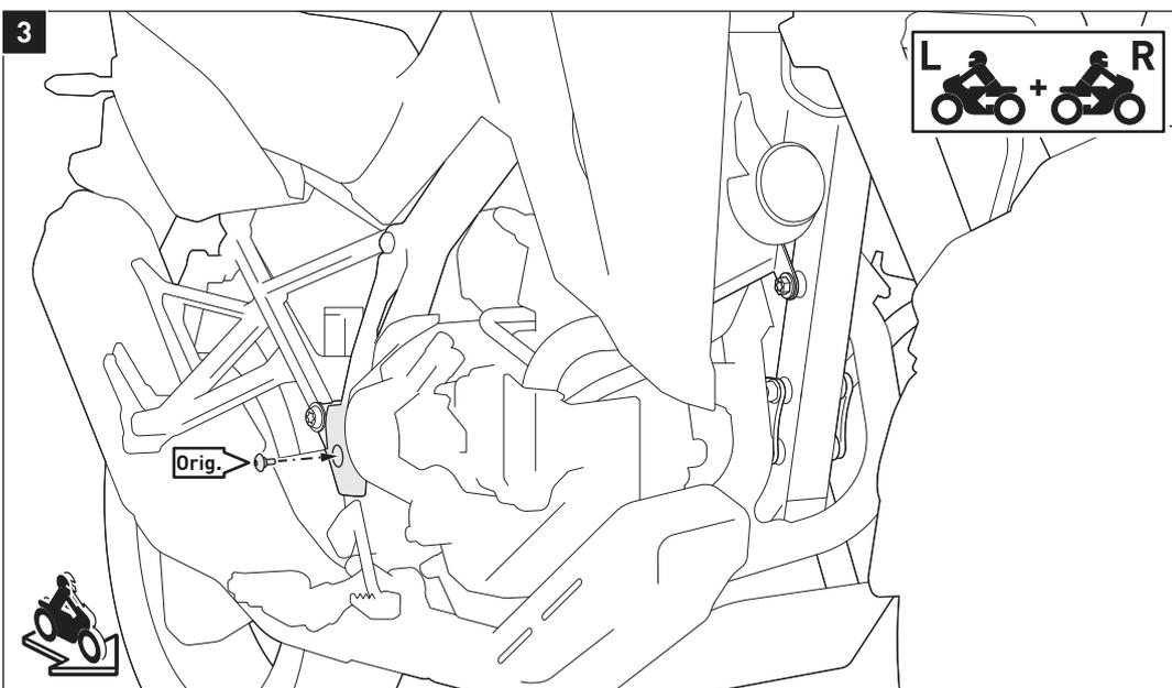
Verschrauben Sie **beidseitig** die Fersenschützer wieder am Fahrzeug. Ziehen Sie die original Schrauben (Orig.) nach Herstellerangaben an.
