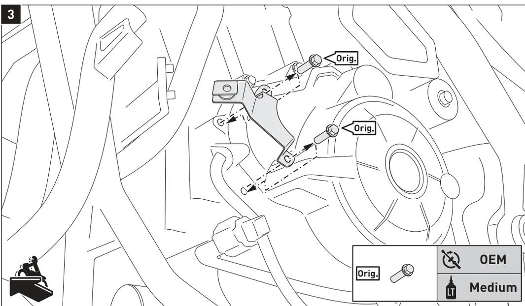
Lösen Sie auf der linken Fahrzeugseite die gezeigten Schrauben und entfernen Sie das Anbaublech.
