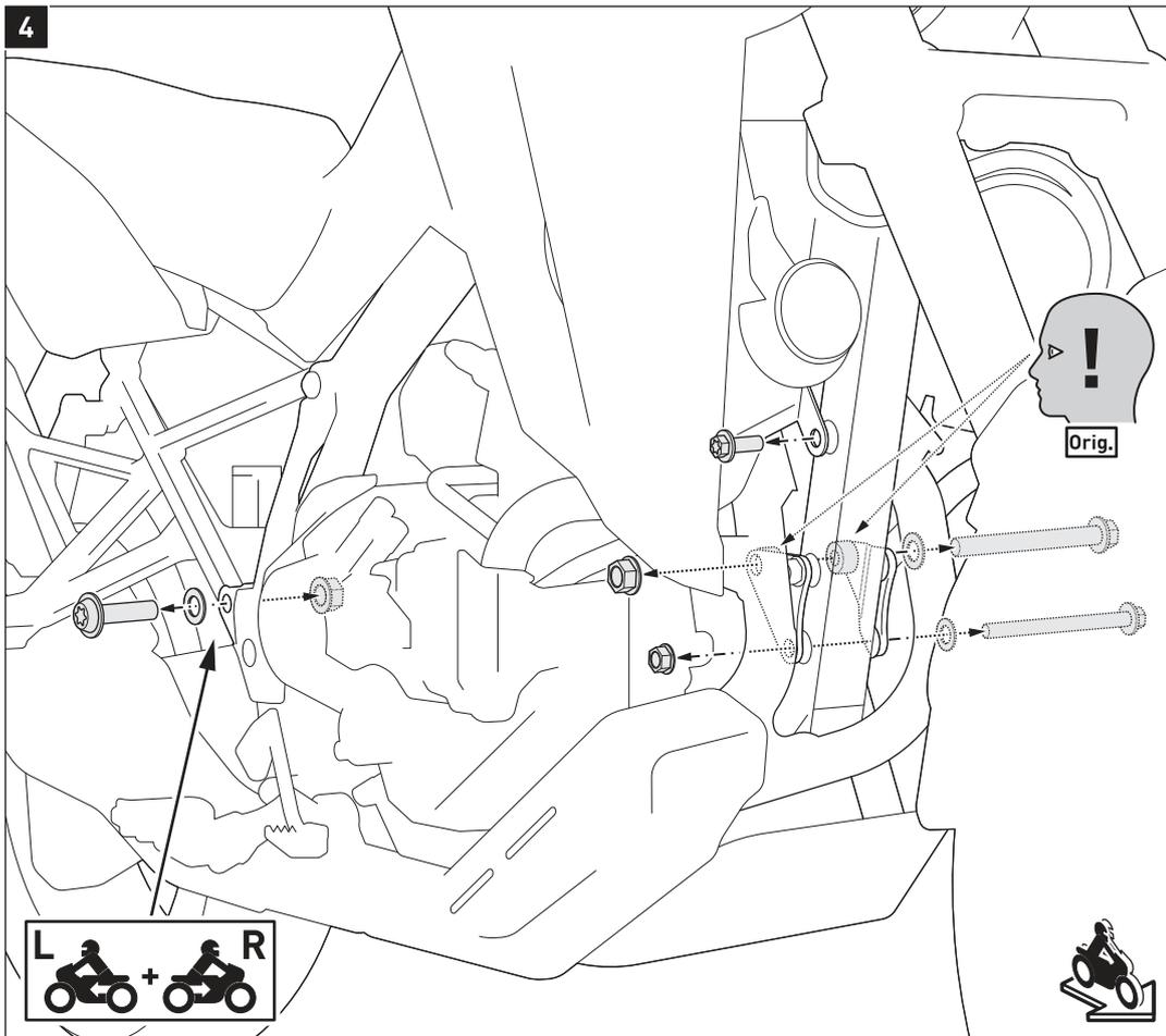
Entfernen Sie die gezeigten original Schrauben, Unterlegscheiben und Muttern **beidseitig** vom Fahrzeug.
