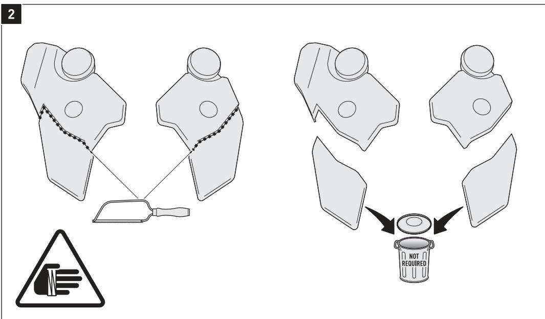
**ACHTUNG: Verletzungsrisiko!** Durchtrennen Sie mit einem geeigneten Werkzeug die Fersenschützer entlang der gestrichelten Linien.
