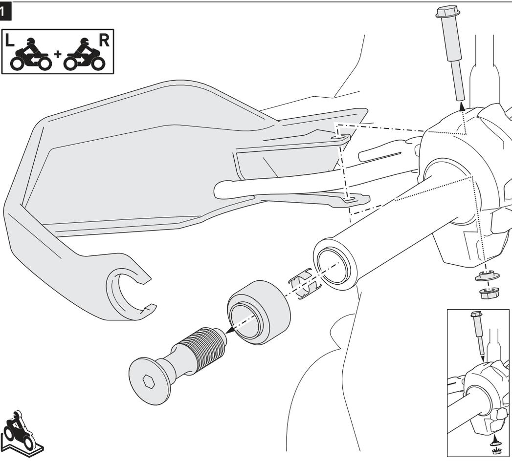
*HINWEIS: Die Montage ist linksseitig dargestellt. Wiederholen Sie die Montage mit den entsprechenden Teilen auf der rechten Lenkerseite analog zur linken Lenkerseite.*
