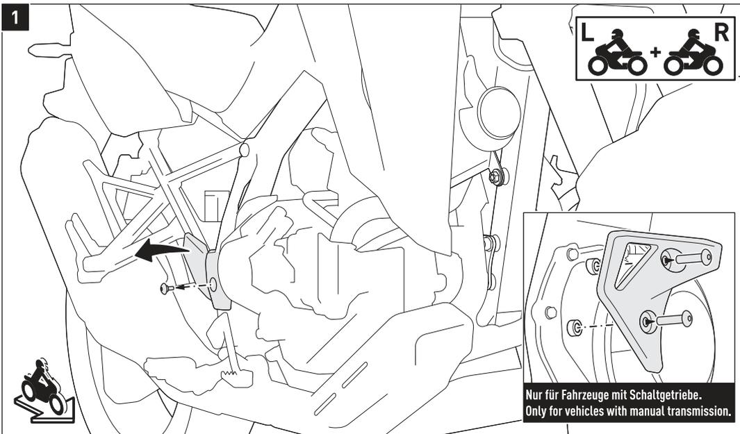
Lösen Sie **beidseitig** die gezeigten original Schrauben und entfernen Sie die Fersenschützer vom Fahrzeug.
