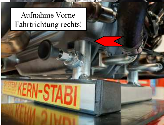
Aufnahmebolzen M10 Bleibt im Motorblock!
