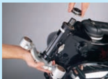
3. Einstellmutter entfernen und Gabelbrücke nach unten herausziehen.
