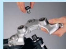
2. Zentralschraube entfernen und Obere Gabelbrücke abnehmen.
