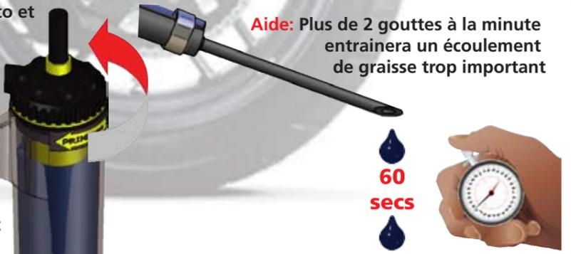
**Aide:** Plus de 2 gouttes à la minute entrainera un écoulement de graisse trop important
