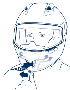
Schakelaar rechts – ventilatie van de wangkussens
