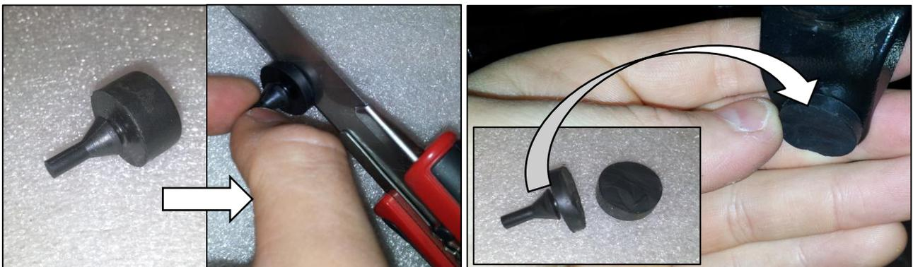
(Gegebenenfalls ist der Gummianschlag des Seitenständers in der Dicke zu halbieren um eine größere Freigängigkeit bei der Abwärtsbewegung des Schalthebels zu erreichen. (Freigängigkeit zwischen Hebel und Seitenständer) Überprüfen Sie ob dies bei Ihnen notwendig ist.
