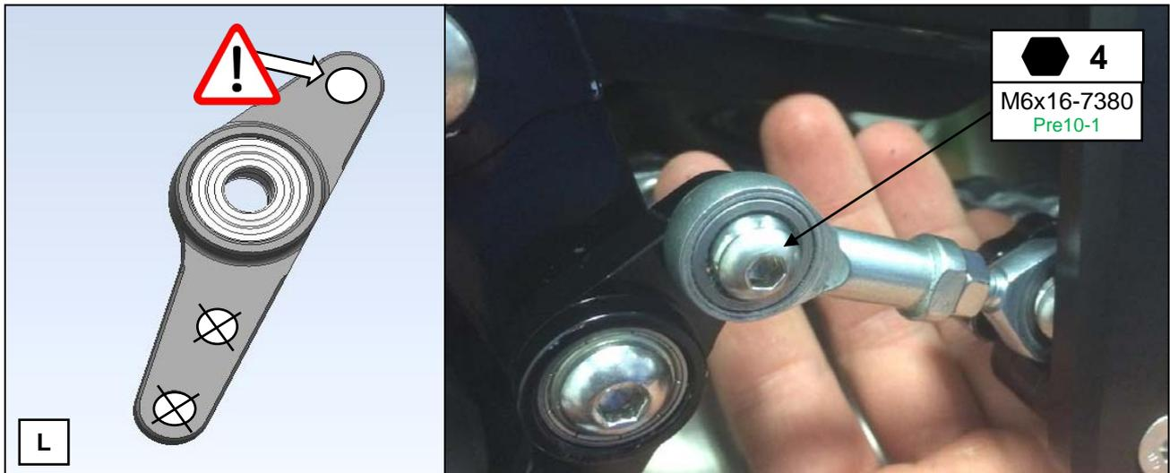
**L:** Befestigen Sie den Kugelgelenkkopf GIKFL6 mittels Schraube **M6x16-7380-Pre10-1** an gezeigter Position an der Schaltwippe USU-05.
