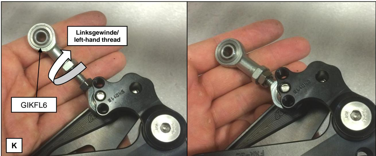
**K:** Drehen Sie den Kugelgelenkkopf **GIKFL6** bis auf Block gegen die Kontermutter auf den Kugelgelenkkopf **GAKFL6** auf. Anschließend die Verbindung nach gleichem Ablauf wie in Schritt G beschrieben festziehen.
