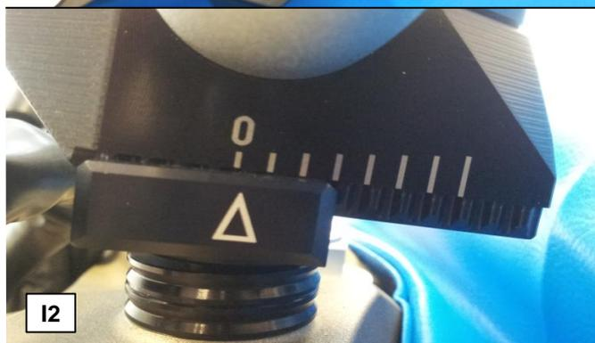
**I:** Drehen Sie beide Lenkerböcke komplett um 180 Grad! Zustand in **Bild I1** (vorher) in Zustand des **Bildes I2** (nachher) ändern!
