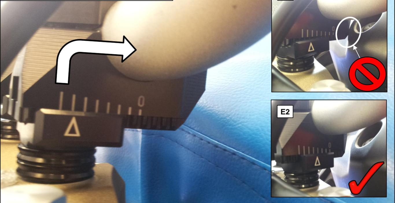
**E:** Das Zurückversetzen des Lenkers erfolgt durch leichtes Anheben und schrittweises Verstellen innerhalb der Verzahnung. Tasten Sie sich an das Maximum Richtung Tank heran und achten Sie stets darauf das beide Lenkerklammern identisch eingestellt sind. Die lasergravierten Teilstriche und der Pfeil helfen Ihnen dabei. Prüfen Sie die gewählte Einstellung auf Kollisionen zum Tank und Freigängigkeit durch vorsichtiges Einschlagen des Lenkers vom rechten zum linken Lenkeinschlag!
