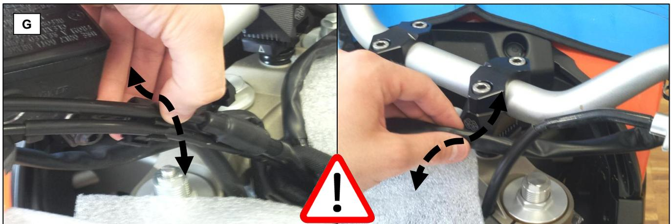
**G:** Überprüfen Sie per Hand auch das Spiel der Bremsleitungen (eventuell Kupplungsleitungen), Kupplungszüge und Kabelbäume in den beiden Lenkanschlägen. Diese dürfen auf keinen Fall gespannt werden beim Lenken, oder gar vor den Lenkanschlägen begrenzen!
