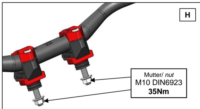
**H:** Im letzten Schritt sind die eingestellten Lenkerböcke mit den beiden Muttern M10 DIN6923 mit der Gabelbrücke zu verschrauben.
