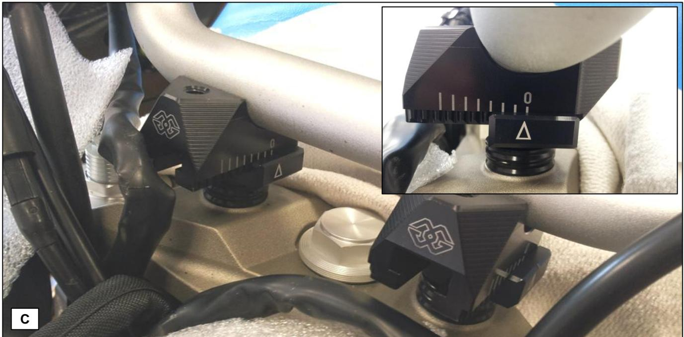
**C:** Setzen Sie die Lenkerklammern auf die Gabelbrücke (Schraubenende durch die Gabelbrücke). Die Einstellung der beiden Klemmböcke muss identisch sein und der Pfeil auf der Null (siehe Schritt B) als Ausgangsstellung! Das Bild zeigt die Ausrichtung der Klammern für die spätere Verstellung in Richtung Tank/ Fahrer (Schritt E).
