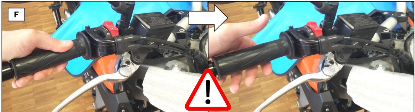
**F:** Es ist zwingend zu kontrollieren, dass der Gasgriff an beiden Lenkanschlägen nach dem Ziehen und Lösen nicht klemmt, sondern in die unbetätigte Grundstellung zurückspringt (komplett widerstandsfrei ohne leichtes Hängen)! Sollte der Gasgriff klemmen, sind die Gaszüge für die gewählte Verstellung in Schritt E zu kurz. Die Klemmen müssen nach Vorne korrigiert werden!
