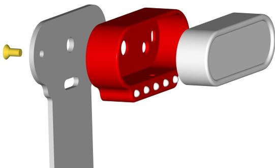
Montage mit Einschweißbecher für die nahtlose Integration in einen Tank (schleifen, schweißen erforderlich)
