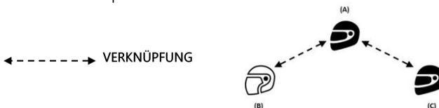
2. Das System A muss die erste Gegensprechverbindung mit dem System B (Universal Intercom) aktivieren. Dazu wird der entsprechende Gegensprechverbindung-Steuerungsbefehl gedrückt.
