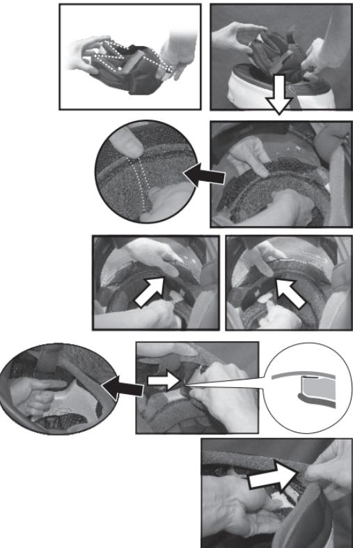
Per riapplicarla, fare la stessa piega a forma di M nella parte anteriore e a forma di V nella parte posteriore dell'imbottitura interna. Facendo attenzione al verso, inserirla nel casco e distenderla.
