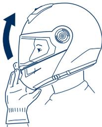
2. Il meccanismo a tirante flessibile sgancia le due chiusure e la mentoniera può essere comodamente sollevata completamente verso l'alto.
