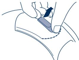
2. Infilare la parte piatta dell'elemento di comando sotto il bordo posteriore della presa e facendo leva verso l'alto sganciarla dal casco.
