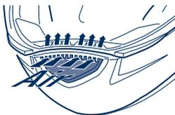
El caudal de aire entrante se dosifica de manera apenas perceptible para el portador del casco, garantizando, no obstante, un eficaz aporte de aire del exterior ya a partir de los aprox. 30 km/h (siempre que el casco se halle completamente en la corriente de aire durante la conducción). De esta forma se contrarresta una tendencia al empañamiento en el visor y una sobreconcentración de CO<sub>2</sub>, incluso cuando el casco está completamente cerrado.
