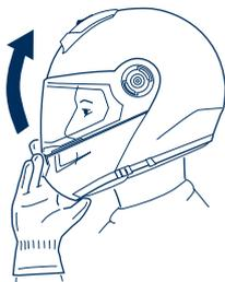
2. El sistema mecánico del cable Bowden desbloquea ambos cierres y Vd. puede subir la carrillera hasta el enclavamiento final.
