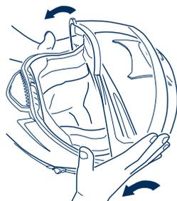
3. Comprobar el funcionamiento del mecanismo, abriendo el visor una vez hasta el tope.
