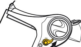
Pour verrouiller l'écran, tournez le levier de blocage dans le sens contraire des aiguilles d'une montre jusqu'à environ 2 heures. Vérifiez si l'écran est correctement verrouillé.
