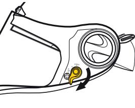
Pour déverrouiller l'écran, tournez le levier de blocage dans le sens des aiguilles d'une montre jusqu'à environ 7 heures. Vérifiez que l'écran est correctement déverrouillé.
