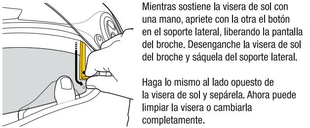
Mientras sostiene la visera de sol con una mano, apriete con la otra el botón en el soporte lateral, liberando la pantalla del broche. Desenganche la visera de sol del broche y sáquela del soporte lateral.
