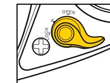
ATENCIÓN: Evite dejar la palanca en la posición de las 4 horas, ya que no es ni bloqueada ni desbloqueada.
