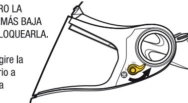
Para desbloquear la pantalla, gire la palanca en el sentido de las agujas del reloj hasta la posición de las 7 horas hasta que se desbloquee. Pruebe ahora la pantalla para comprobar si está adecuadamente desbloqueada.
