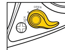
ACHTUNG: Lassen Sie den Hebel nicht in der 4-Uhr-Position, in der er weder verriegelt noch entriegelt ist.
