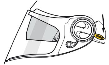
Zum Senken der Sonnenblende einfach den Hebel zum Abnehmen der Sonnenblende nach unten ziehen.
