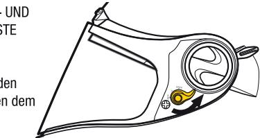
Zum Entriegeln des Visiers den Verriegelungshebel im Uhrzeigersinn auf ungefähr 7 Uhr drehen, bis er sich entriegelt. Nachprüfen, ob das Visier richtig entriegelt ist.
