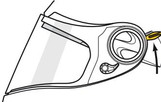
Zum Heben der Sonnenblende einfach den Hebel zum Abnehmen der Sonnenblende nach oben drücken.
