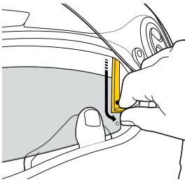
Tout en maintenant l'écran interne de protection solaire d'une main, tirez avec l'autre main sur le bouton du support latéral, dégageant ainsi l'écran de l'attache. Sortez l'écran de ses attaches et retirez-le du support latéral. Procédez de même de l'autre côté afin de dégager complètement l'écran.
