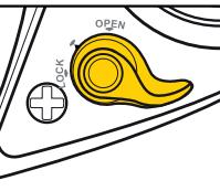
REMARQUE : Evitez de laisser le levier dans la position illustrée de 4 heures, l'écran est alors ni verrouillé, ni déverrouillé.
