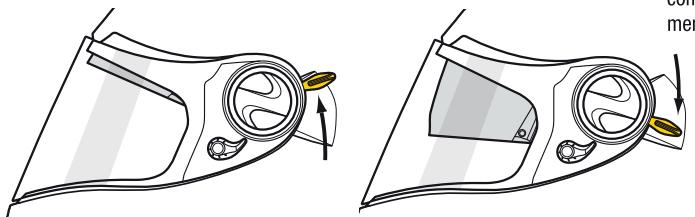
Para elevar la visera de sol, sólo tiene que empujar hacia arriba la palanca de repliegue de la visera de sol interna.
