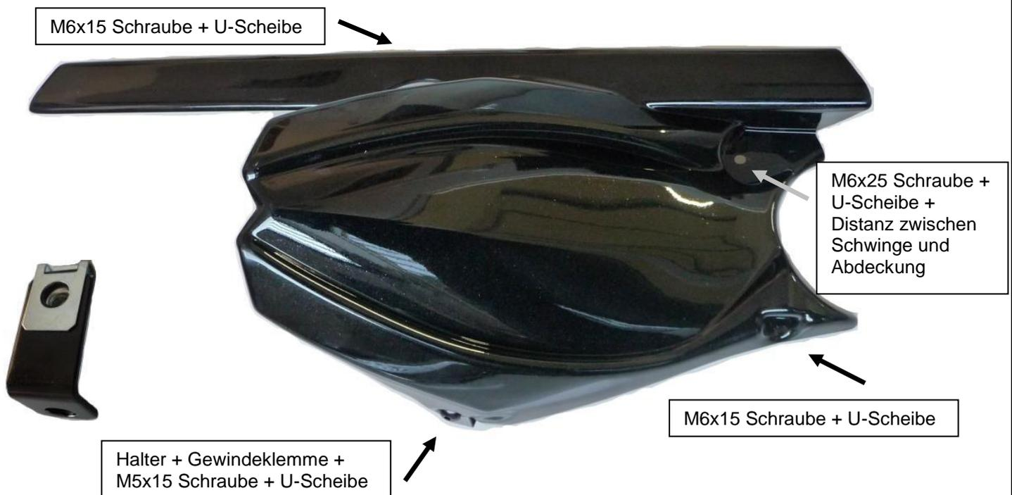
1. Demontieren Sie den Kettenschutz und den Bremsleitungshalter.
