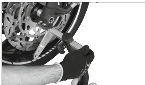
Ustalić pozycję mocowań poprzez dokręcenie śrub z uchwytem gwiazdowym, aby zabezpieczyć motocykl przed zsunięciem z podnośnika podczas wykonywania czynności konserwacyjnych.
