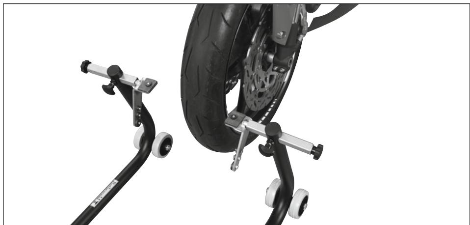
При установке опор для переднего колеса и V-образных опор соблюдайте ориентацию переходников – см. примеры монтажа.
