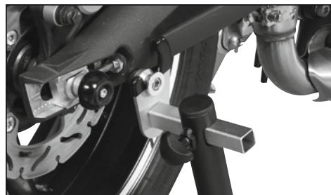
Per prima cosa controllare se sul braccio oscillante dell'alzamoto Rothewald sono presenti nottolini adatti avvitati in modo sicuro. Eventualmente è necessario applicare prima dei nottolini da acquistare separatamente sugli appositi filetti interni del braccio oscillante.
