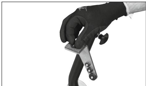
Сначала проверьте наличие отверстия внизу труб первьев вилки и его размер. Всего имеется четыре разных размеров переходников: 12 мм, 14 мм, 16 мм и 22 мм. Выберите переходник подходящего размера и вверните в резьбу защитной фетровой накладки. При необходимости сначала снимите установленный ранее переходник.
