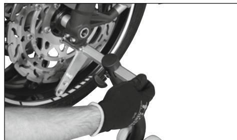
Avvitare saldamente in posizione con le viti con manopole a crociera dei supporti, in modo che la moto non possa scivolare durante gli interventi di manutenzione.
