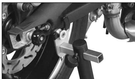
В первую очередь убедитесь, что на маятниковой вилке имеются подходящие для мотоциклетного подъемника Rothewald, надежно прикрученные призматические втулки. В противном случае установите отдельно приобретаемые призматические втулки в специально предназначенные для этого внутренние резьбы на маятниковой вилке.
