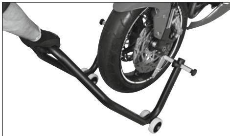
Następnie - trzymając za rurę łączącą - silnym, powolnym i jednostajnym ruchem wsunąć podnośnik motocyklowy Rothewald pod pojazd, tak by spoczął na pewnie na podnośniku.
