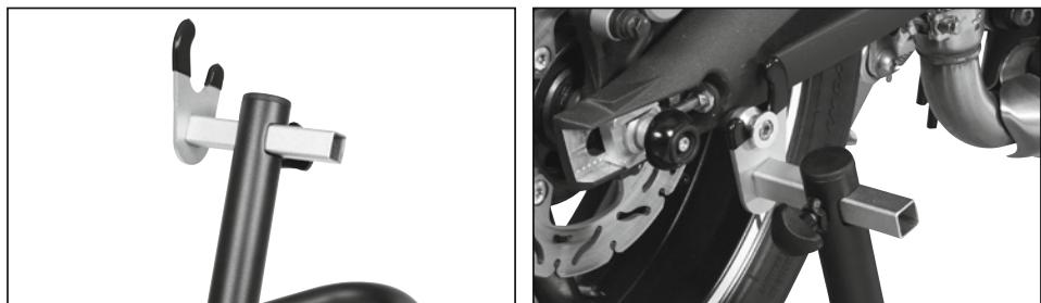
Zunächst prüfen, ob an der Schwinge für den Rothewald Motorradheber geeignete, sicher verschraubte Prismabuchsen vorhanden sind. Ggf. müssen separat zu erwerbende Prismabuchsen an den dafür vorgesehenen Innengewinden an der Schwinge angebracht werden.
