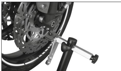
Dopasować podnośnik motocyklowy Rothewald do szerokości widelca przedniego koła za pomocą adapterów do rury nośnej teleskopu. Podczas tej czynności druga osoba musi trzymać kierownicę prosto. Wsunąć mocowania z odpowiednimi adapterami od przodu pod rury nośne teleskopu. Dosunąć mocowania, aby wsunęły się całkowicie pod obie rury nośne teleskopu, a adaptery wpasowały się w otwory w rurach nośnych.
