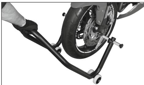
Dann den Rothewald Motorradheber am Verbindungsrohr kraftvoll, aber langsam und gleichmäßig unter das Fahrzeug drücken, bis dieses auf dem Motorradheber ruht.
