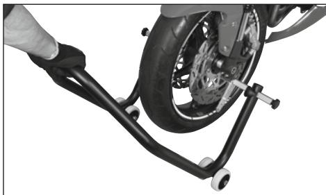
Затем, сильно, но медленно и равномерно, нажимая на соединительную трубу, вожмите мотоциклетный подъемник Rothewald под транспортное средство, чтобы оно повисло на мотоциклетном подъемнике.
