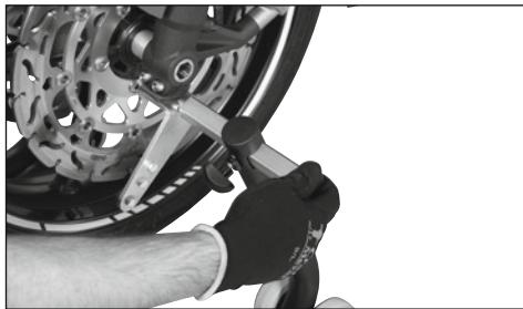
После этого зафиксируйте положение болтами со звездообразной головкой на опорах, чтобы во время работ по техническому обслуживанию мотоцикл не сдвинулся.
