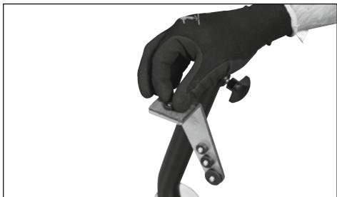
Zunächst ist zu prüfen, ob die Gabelstandrohre unten eine Öffnung haben und wie groß diese Öffnung ggf. ist. Es stehen insgesamt vier verschiedene Adaptergrößen 12 mm, 14 mm, 16 mm, 22 mm zur Verfügung. Eine geeignete Adaptergröße wählen und auf das Gewinde der Filzschutzfläche schrauben. Unter Umständen muss der bereits montierte Adapter vorher demontiert werden.
