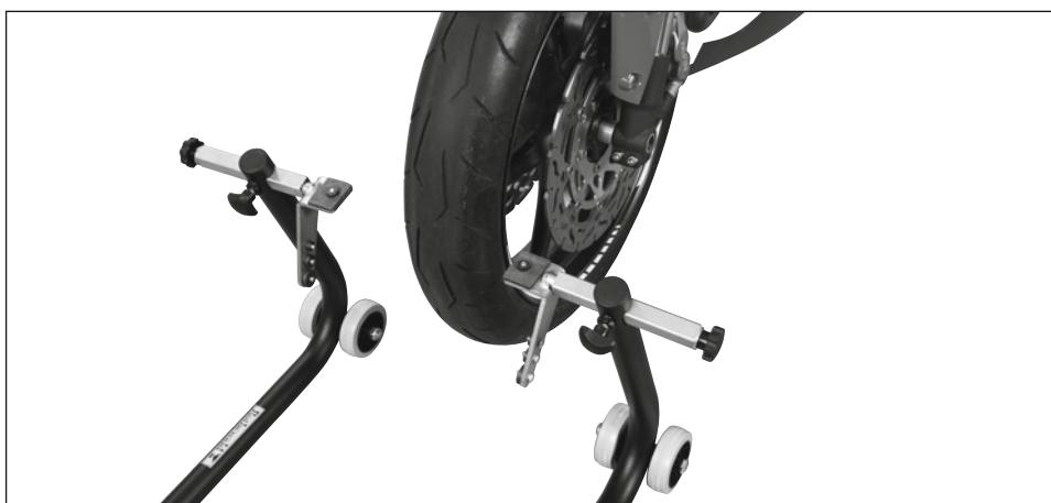
Quando si inseriscono i supporti per ruota anteriore e i supporti a V prestare attenzione all'allineamento degli adattatori (vedere gli esempi di montaggio).
