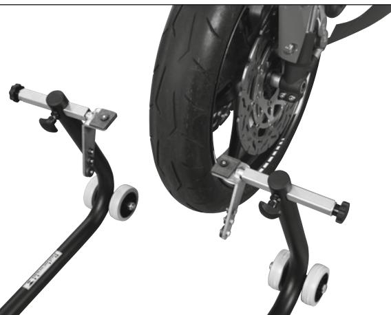
Preste atención a la orientación de los adaptadores al introducir los alojamientos para la rueda delantera y los alojamientos en V; véanse los ejemplos de montaje.
