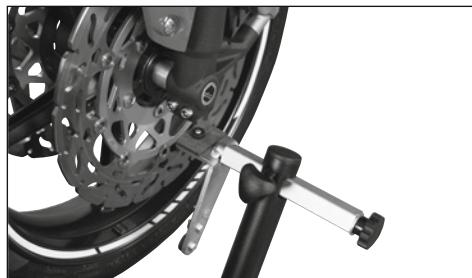
Den Rothewald Motorradheber mit den Aufnahmen für unten offene Gabelstandrohre auf die Breite der Vorderradgabel einstellen. Dazu hält eine zweite Person den Lenker in gerader Position. Die Aufnahmen mit den passenden Adapters von vorne unter die Gabelstandrohre des Motorrades her-anführen. Die Aufnahmen so verschieben, dass diese komplett unter beide Gabelstandrohre passen und die Adapter in die Öffnung/ Bohrung der Gabelstandrohre passen.
