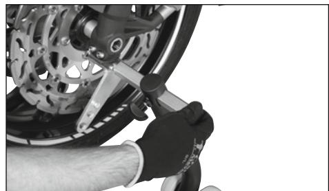
Schroef de steunpunten daarna vast met de stervormige knopschroeven, zodat de motor tijdens de werkzaamheden niet kan wegglijden.
