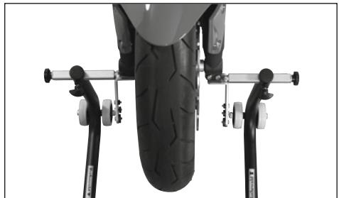
Zorg dat de adapters goed in de openingen passen en dat er niet veel spelting is. Zet de steunpunten vast met de knopschroeven.
