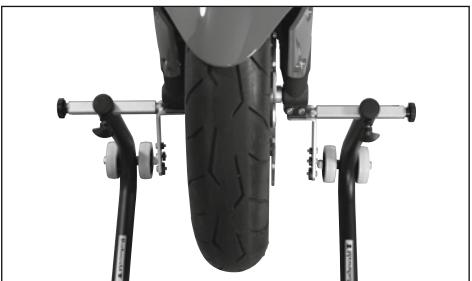
Veillez à ce que les adaptateurs s'insèrent bien dans l'ouverture et à ce qu'il n'y ait pas trop de jeu. Fixez les supports à l'aide des vis à garret.
