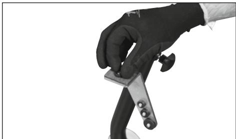
Per prima cosa è necessario controllare se gli steli della forcella presentano un'apertura nella parte inferiore ed eventualmente le sue dimensioni. Sono disponibili adattatori di quattro dimensioni diverse: 12 mm, 14 mm, 16 mm e 22 mm. Scegliere un adattatore di dimensioni adatte e avitarlo sul filetto della superficie di protezione in feltro. In alcuni casi potrebbe essere necessario prima smontare l'adattatore già montato.
