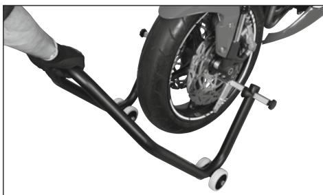
Poussez ensuite vigoureusement, mais lentement et de manière homogène, la béquille d'atelier Rothewald contre le tube de raccordement au-dessous du véhicule jusqu'à ce que ce dernier repose sur la béquille d'atelier.
