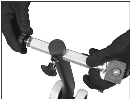
Die beiden Rothewald Hinterradheber-Modelle sind für einen inneren Schwingenabstand von 270 bis 360 mm geeignet.
