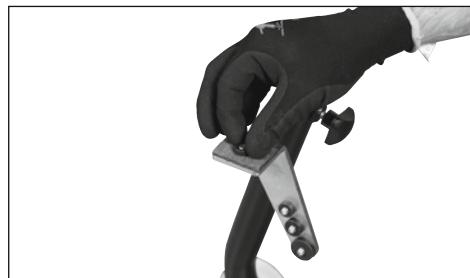
En primer lugar, compruebe si las barras de horquilla presentan un orificio en su extremo inferior y, en su caso, mida el tamaño de dicho orificio. En total dispone de cuatro adaptadores de diferentes tamaños: 12 mm, 14 mm, 16 mm, 22 mm. Seleccione el adaptador del tamaño adecuado y atorníllelo a la rosca de la superficie con fielro protector. Es posible que antes deba desmontar el adaptador que ya está montado.
