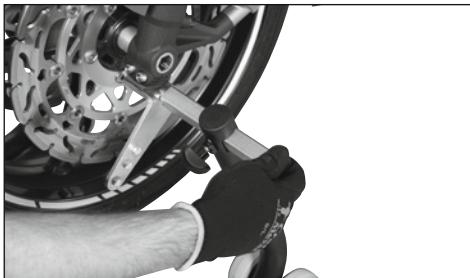
Vissez ensuite en position en serrant à fond les vis à poignée étoile des supports pour que la moto ne puisse pas glisser pendant les travaux de maintenance.
