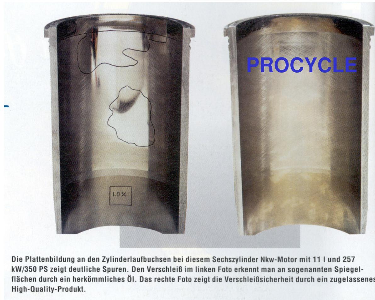
Die Plattenbildung an den Zylinderlaufbuchsen bei diesem Sechszylinder Nkw-Motor mit 11 l und 257 kW/350 PS zeigt deutliche Spuren. Den Verschleiß im linken Foto erkennt man an sogenannten Spiegelflächen durch ein herkömmliches Öl. Das rechte Foto zeigt die Verschleißsicherheit durch ein zugelassenes High-Quality-Produkt.
