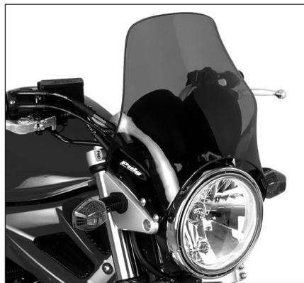
Wenn das Fahrzeug überholt wird, sollten jedesmal auch alle Schrauben des Windschildes nachgezogen werden, vor allem die Schrauben die das Windschild an das Fahrzeug befestigen.
