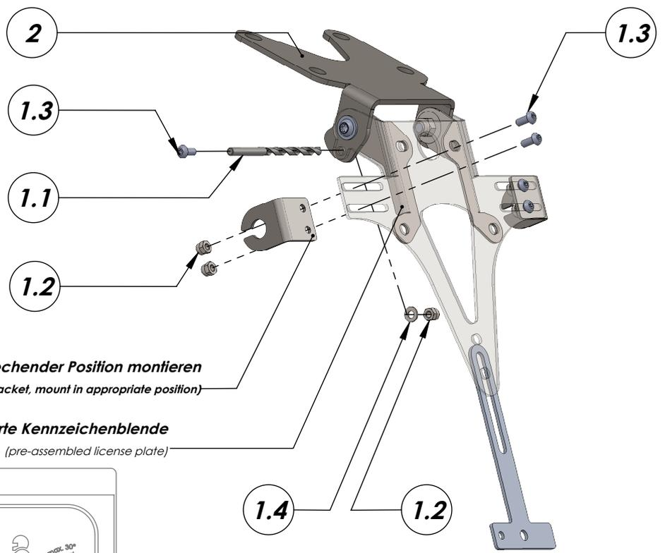
**3** Blinkerhalter in entsprechender Position montieren
