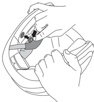
2. Crocheter les extrémités crochues des sangles de cou derrière les vis frontales. Insérer ensuite les dispositifs de fixation des sangles de cou dans les broches situées entre la coque du casque et la coque interne.
