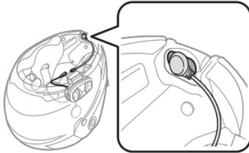
3. Schließen Sie die Mikrofonkabel unter Beachtung der Pfeile am Mikrofonanschluss der Haupteinheit an.
