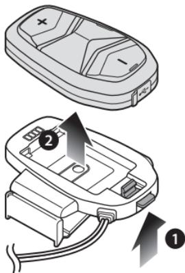
2. Halten Sie die Lasche in der Mitte der Klemmeinheit gedrückt und drücken Sie gleichzeitig die Rückplatte der Klemmeinheit nach außen, um sie zu entfernen.
