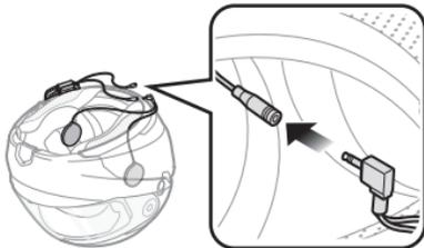
3. Schließen Sie die Mikrophonkabel unter Beachtung der Pfeile am Mikrophonanschluss der Haupteinheit an.
