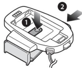
3. Bringen Sie den selbstklebenden Befestigungsadapter in eine Linie mit der Rückseite der Klemmeinheit und schieben Sie den Adapter in die Klemmeinheit, bis Sie ein Klicken hören. Stellen Sie sicher, dass der selbstklebende Befestigungsadapter fest in den Nuten der Rückseite der Klemmeinheit sitzt.
