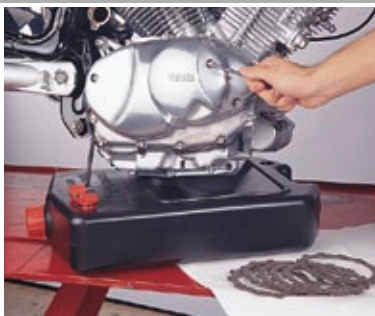
Werkzeug bereitlegen – Boden abdecken – Öl ablassen
