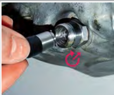
Einbau eines Stahlbus Ölablass-Ventil
