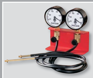
Dépressiomètre avec 2 manomètres
