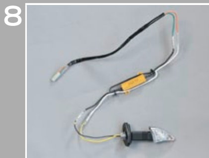
8 Korrektur verkabelt: Blinker, Leistungswiderstand, Adapterkabel
