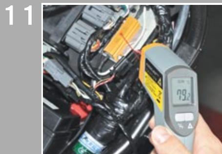
11 Infrarot-Thermometer zeigt schon nach wenigen Minuten 79°C an
