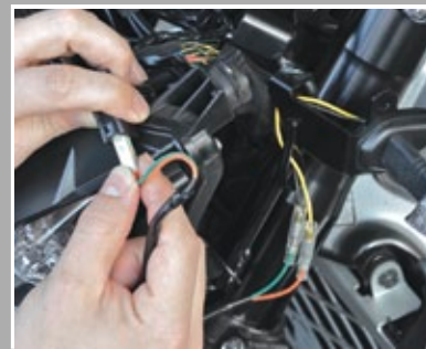
Durch Adapterkabel bleibt der Kabelbaum unversehrt
