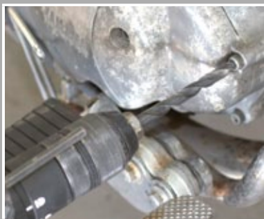
Abbohren des defekten Schraubenkopfes
