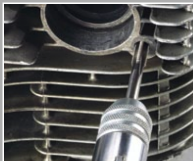
... Gewinde für V-Coil-Reparatur-Einsatz schneiden ...
