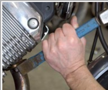
Mutter mit Hammer und Meißel lösen
