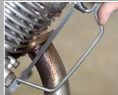
Mutter mit Säge aufschlitzen
