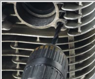
V-Coil-Reparatur: defektes Gewinde wegbohren ...
