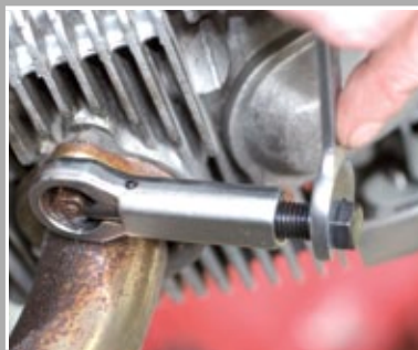
Mutter mit Mutternsprenger spalten
