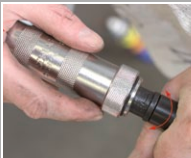
Drehrichtung des Schlag-schrauber einstellen ...
