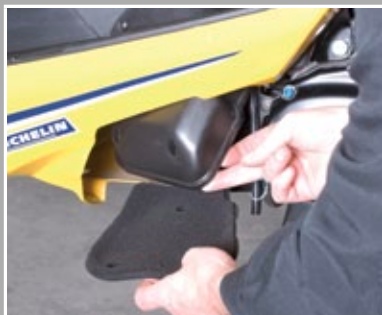
Luftfilter ausbauen, reinigen und Schaumstofffilter leicht einölen
