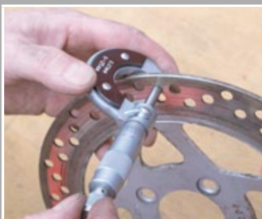
Bremsscheibe mit einer Micrometerschraube prüfen
