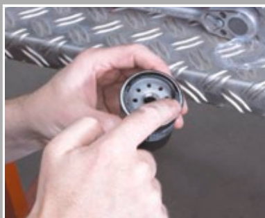
Neuen Patronenfilter am Dichtring leicht einölen und montieren
