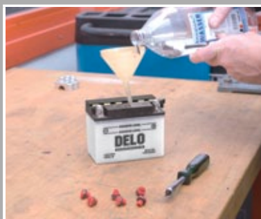
Säurebatterien regelmäßig mit destilliertem Wasser auffüllen
