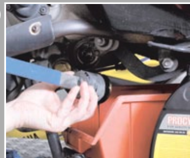
Ölfilter abschrauben und Restöl in die Wanne laufen lassen
