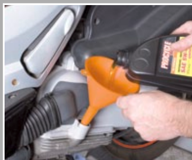
Öl in der richtigen Viskosität und Menge einfüllen
