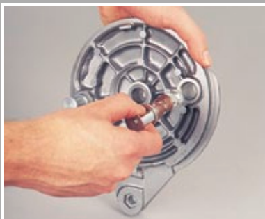
Bremswelle gängig machen und mit Kupferpaste fetten
