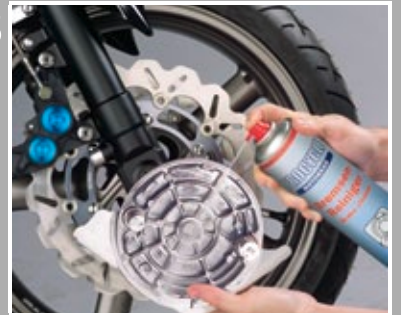
Bremsträgerplatte mit Bremsenreiniger säubern
