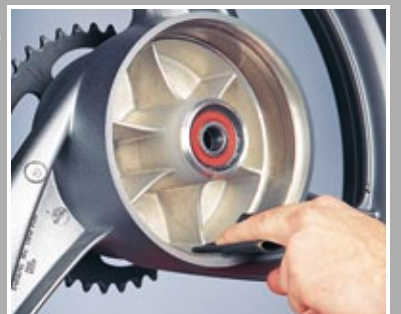
Bremstrommel prüfen, ggf. mit Schleifpapier glätten
