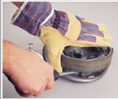
Alte Bremsbacken abhebeln
