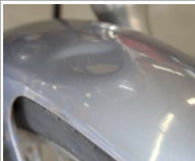
Schutzblech mit Beule und Roststelle
