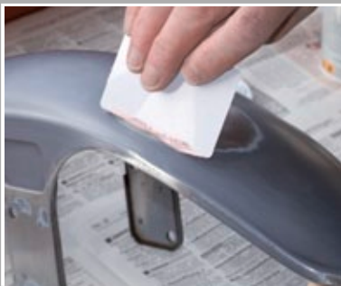
Spachtelmasse auftragen und glattschleifen...
